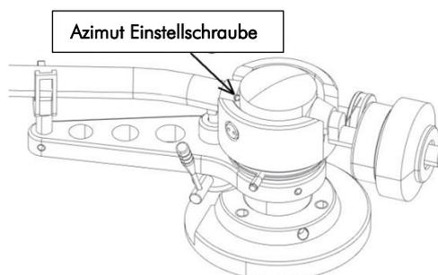
Dazu stellen Sie das Geodreieck mit seiner Basislinie auf den Plattenteller und richten die Oberkante des Tonabnehmergehäuses an den Parallellinien aus.
