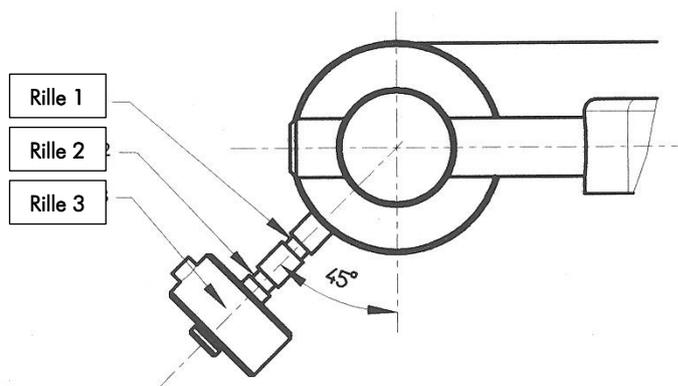
Der Wert für die Antiskating-Einstellung wird in Abhängigkeit zur eingestellten Auflagekraft gewählt. Hängen Sie die Schlaufe des Antiskating-Gewichts (15) in die entsprechende Rille des Bolzens (16), und führen Sie den Faden über die Rille des Führungsbolzens.
