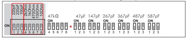
Beim Einstellen ist die Kapazität des Phonokabels zu berücksichtigen. Die Kapazität des Kabels muss zum eingestellten Wert addiert werden. Die Summe der Werte ist die Kapazität, auf die sich die Herstellerangabe zur Abschlusskapazität bezieht.
